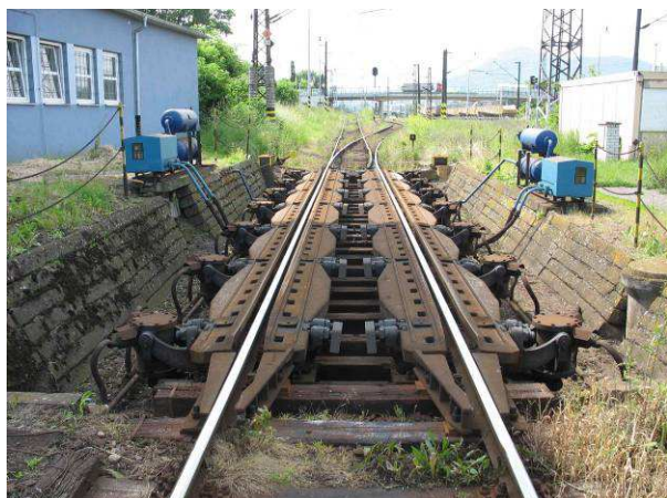
V rámci stavby dojde k odstranění stávající kolejové brzdy a svážného pahrbku.
